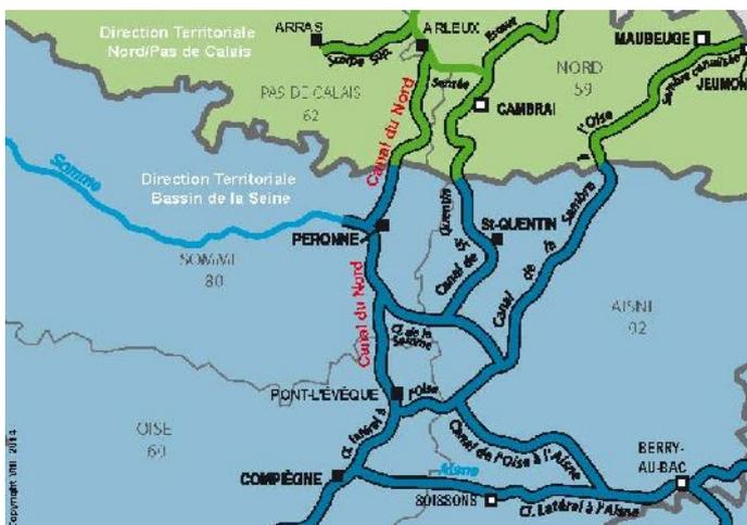
Le canal du Nord est situé sur un itinéraire à moyen gabarit (de 600 à 1000 tonnes) qui relie les bassins de l'Oise et de l'Escaut. Il comprend 19 écluses et 2 souterrains sur 95 km de voies navigables et 17 stations de pompage pour remonter l'eau du canal. En moyenne annuelle, 8 500 bateaux de commerce circulent sur le canal du Nord pour un trafic de 2,7 millions de tonnes de marchandises (chiffres 2013).
