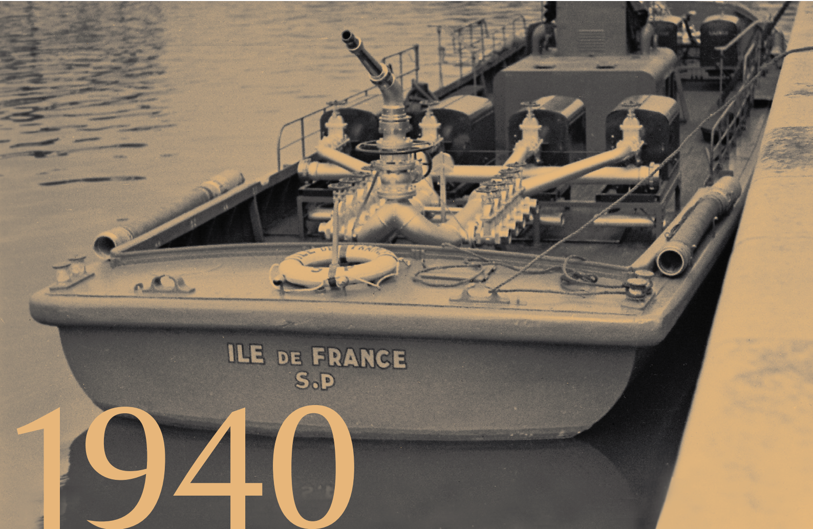
Equipement hydraulique (deux groupes de quatre motopompes) du bateau-pompe Ile de France , 1942.
