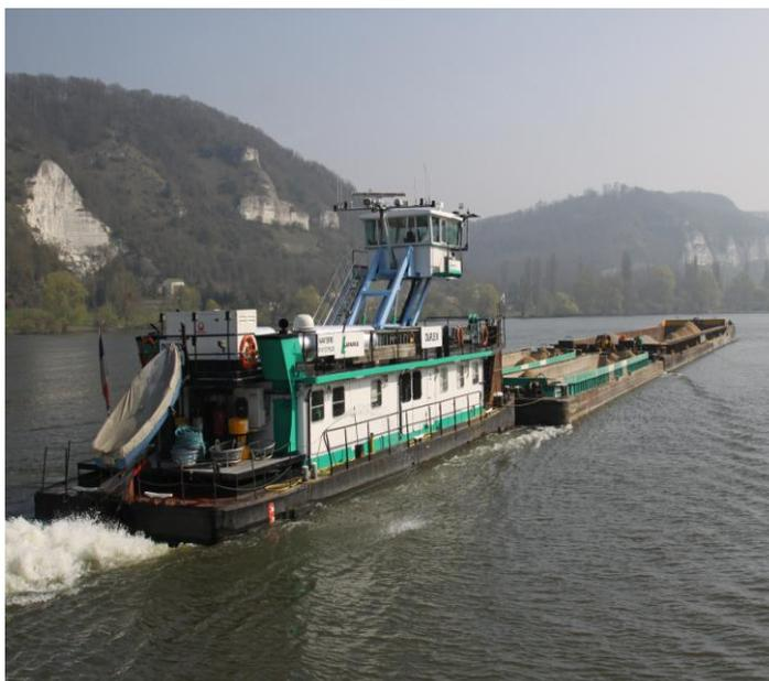
**Barge** : embarcation de charge, dépourvue de moteur et d'habitation, utilisée généralement en convoi poussé.
